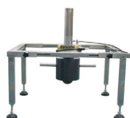
MT 472 Устройство для испытания кры- шек центрифуг, стиральных машин на механическую прочность
